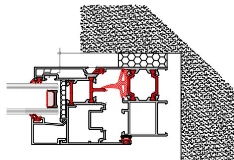
Para garantizar la resistencia al agua, al viento y al ruido, la junta debe ejecutarse con materiales idóneos de manera que se asegure la integridad de los mismos en el tiempo. Como ejemplo, la junta de dilatación está constituida por los materiales siguientes:
