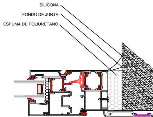
Para obtener un óptimo funcionamiento termo-acústico de la ventana instalada, la velocidad de aplicación del poliuretano tiene que ser tal que se obtenga un cordón no superior a 20mm. Durante el secado del mismo aumentará el volumen, pero dicho incremento no es constante a lo largo del cordón y no es necesario que la espuma alcance el borde del marco, ya que, es más correcto técnicamente que quede en el interior que recortar el exceso.
