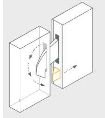
**Paso 2:** Accionamiento de la manivela y apertura de los bulones de seguridad
